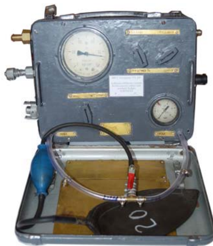
Рис. 5. Установка эжекторная УЭ-1М с приспособлением для набора пробы шахтного воздуха в камеру без буферного резервуара (пробонаборного устройства), состоящим из Т-образного соединительного тройника, крана шарового и груши резиновой от шахтного интерферометра типа ШИ
