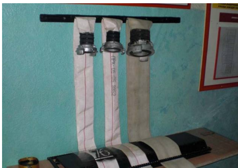
Рис. 3. Общий вид устройства для маркировки пожарных напорных рукавов диаметром 51 и 77 мм
