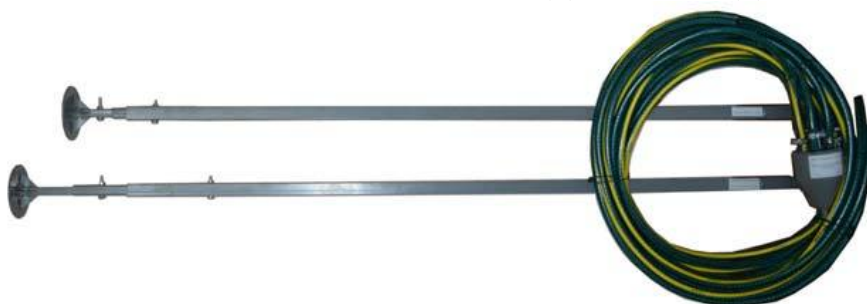
Рис. 2. Многоточечный пробоотборник УСДОП
