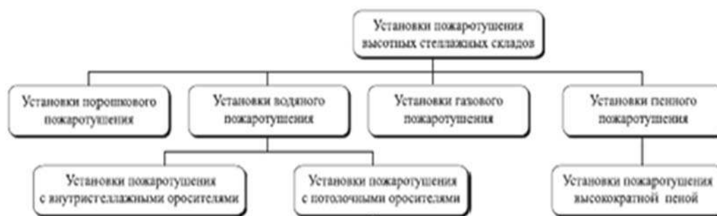
Рис. 1. Классификация систем пожаротушения высотных стеллажных складов
