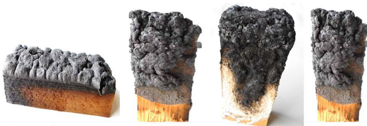
Рис. 2. Защитный слой покрытий на древесине после термического воздействия
