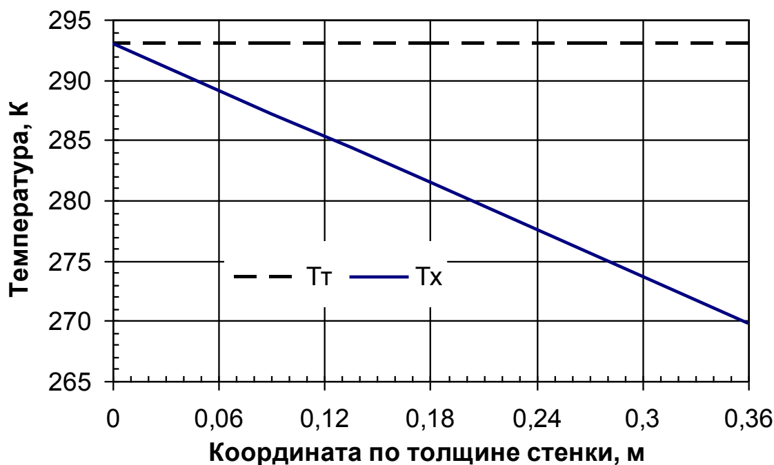
Рис. 1. Распределения температур в стенке из красного кирпича для теплого T_{\text{т}} и холодного T_{\text{х}} периодов года
