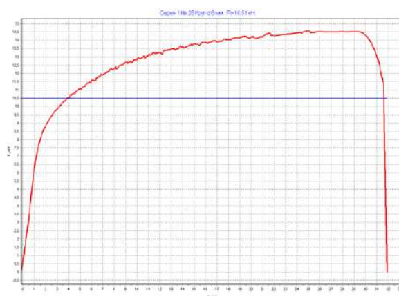
Рис.4. График разрушения образца, нагретого до температуры 500°C.
