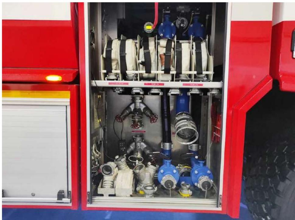
Рис. 4. Установлен насос от завода Пожгидравлика
