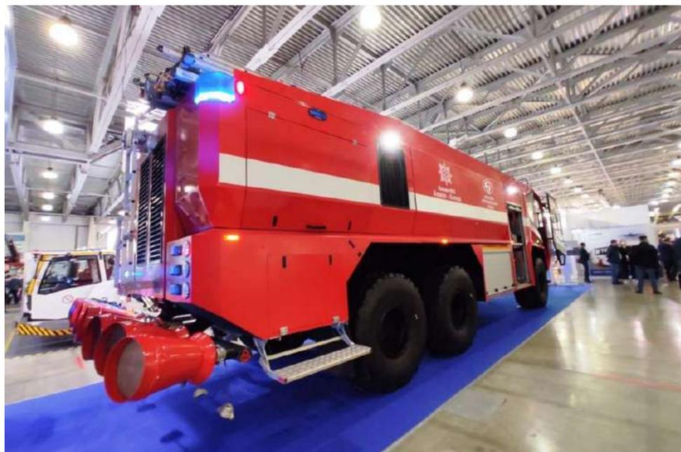
Рис. 6. Комплекс ГПС-600, установленный на заднем бампере ПА
