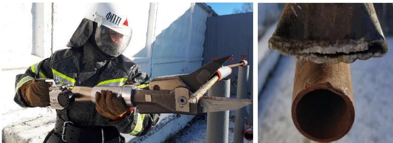
Рис. 3. Рез различных металлоконструкций пиротехническими ножницами НП-4
