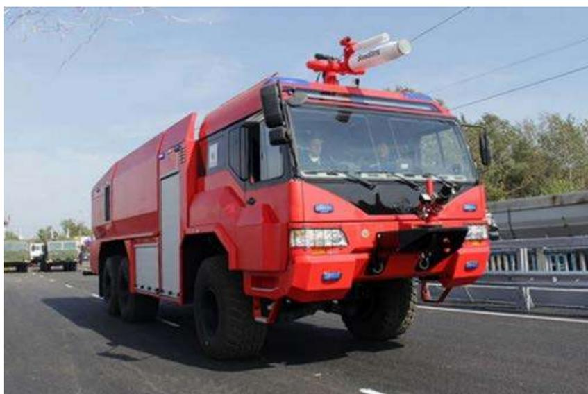
Рис. 2. Первый вариант аэродромного ПА БАЗ с китайской кабиной
