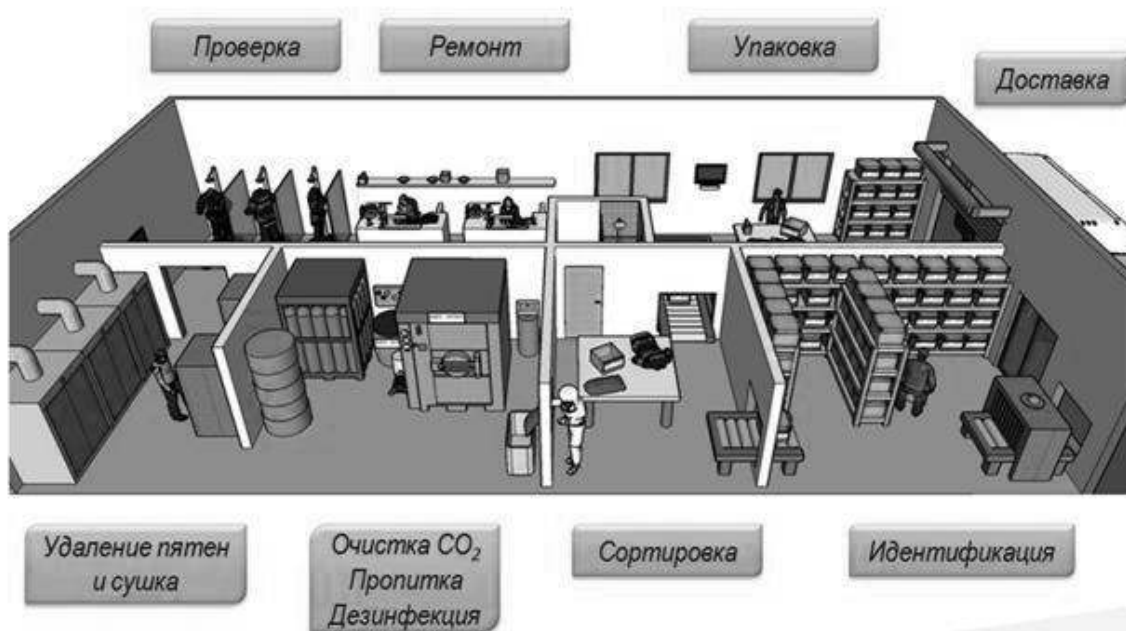
Рис. Технологический комплекс обслуживания БОП
