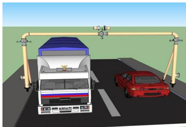
Рис. 2. Общий вид рукавного моста
