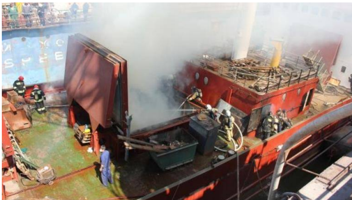
Рис. 2. Работа водяных стволов при тушении пожара в трюме сухогруза «Санни Мария»
