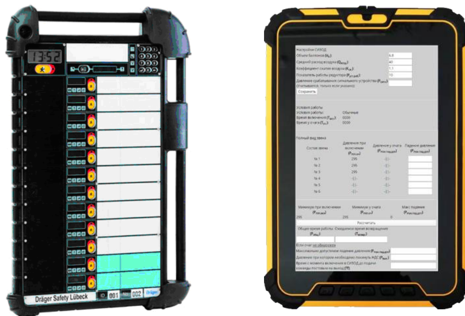
Рис. Контрольно-сигнализирующее устройство Bodyguard II (слева) и защищенный планшет с приложением «Калькулятор ГДЗС» (справа)
