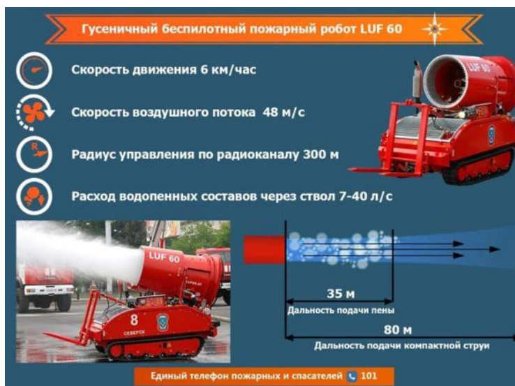
Рис. 4. Австрийский пожарный робот LUF 60 [2]
