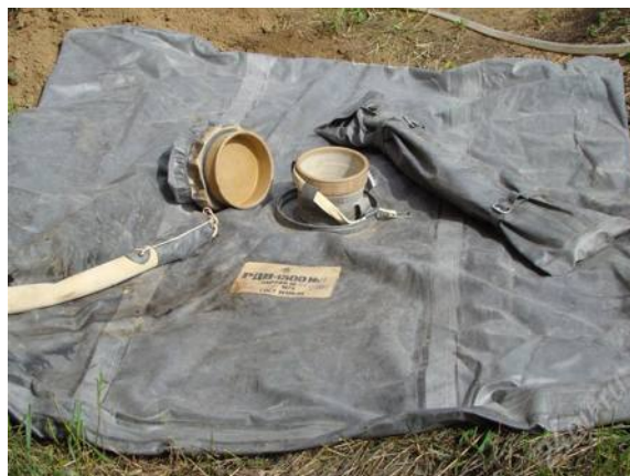
Рис. 4. Гибкая емкость для перевозки воды в кузове автомобиля
